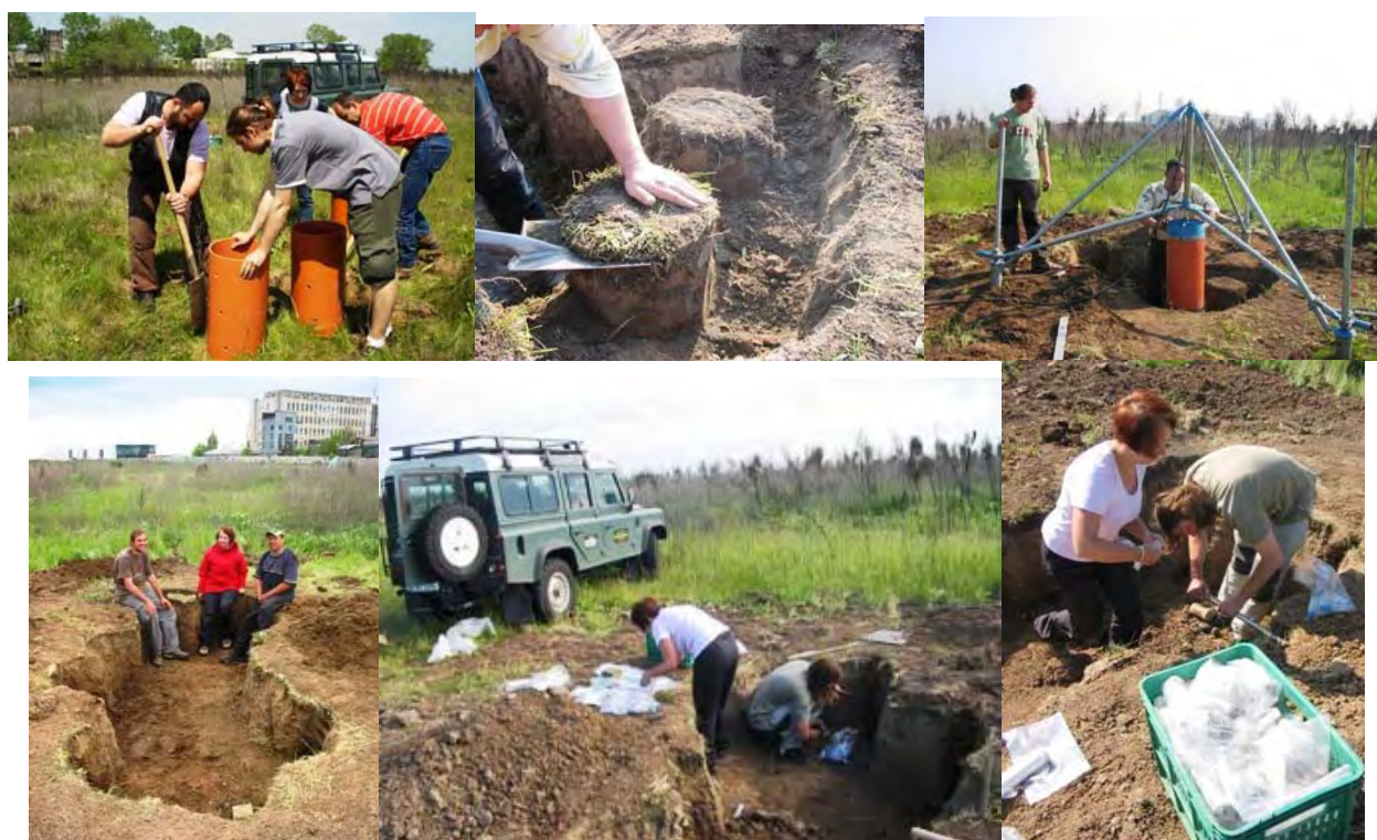
Figura 2 Imagini de la prelevarea solului pentru lisimetre și prelevarea probelor pentru determinarea concentrațiilor de metale în sol.
