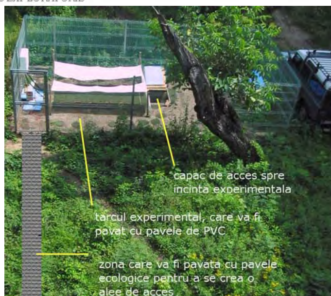
Figura 2 Imagine a unei instalații cu lisimetre similară cu cea care va fi folosită în proiect (cu acordul lui R. G. McLaren, Lincoln University, Noua Zeelandă).
