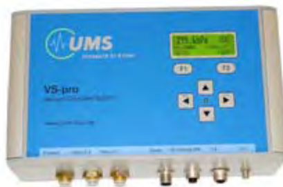
Figura 14 Unitate cu 2 canale vidate pentru ajustarea circuitului vacumului
